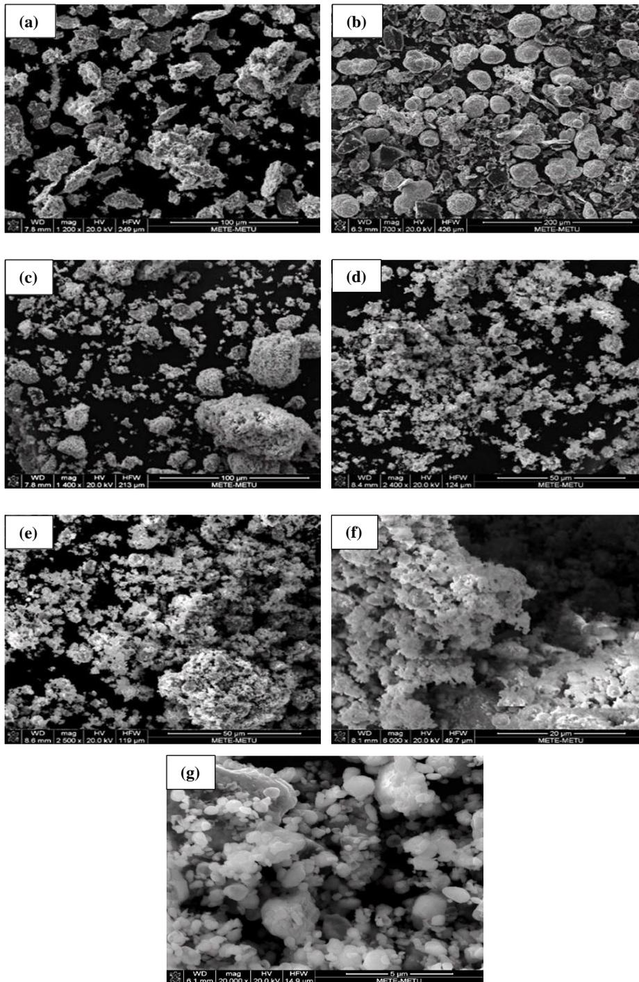
Figure 4.11 SEM images for  $\text{Ni}_{60}\text{B}_{40}$  composition powder milled for (a) 0 h (initial), (b) 5 h, (c) 10 h, (d) 20 h, (e) 40 h, (f) 60 h, (g) 80 h
