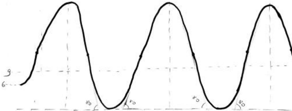
Trenin tepe noktaya çıktığında dönüş yapabilmesi için tren yolunun oval olması gerekir. Trenin indisi en uc noktadaki yolun da dönüş yapabilmesi için oval olması gerekir. Yani en yüksek ve en alçak noktalarda eğim minimumdur, hatta 0'dır.
