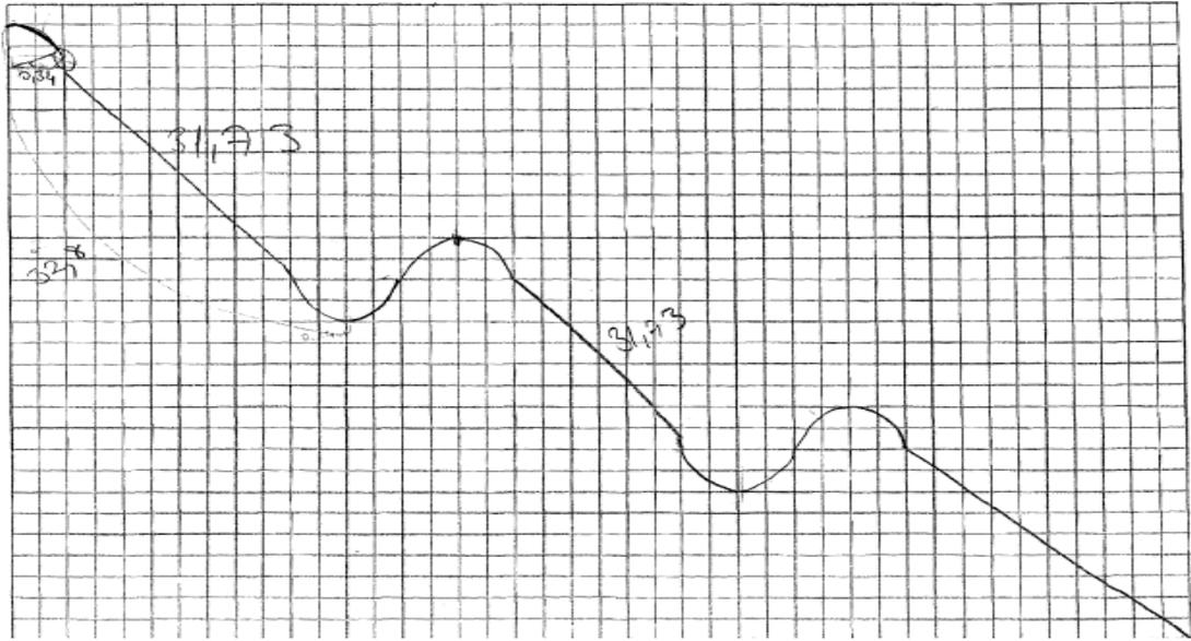
→ Öncelikle heyecan yaratmak için temel olarak inişleri kullanırken, çıkışları sadece inişin monotonluğundan kurtulmak için minimum miktar da kullandık. Başlangıçta trenimize irtifa kazandırmaya çalışıp mesafemizi harcamamak için trenimizi "0" noktasından direkt olarak aşağı indirdik. Kullandığımız çeyrek çemberlerin yarıçapları 0,34 iken, trenimizin ilk dönüştüğü yerin başlangıç noktasına uzaklığı 32,8 ve ilk çeyrek çemberimizin (başlangıç) ikinci çeyrek çemberimize uzaklığı 31,73 m'dir.
