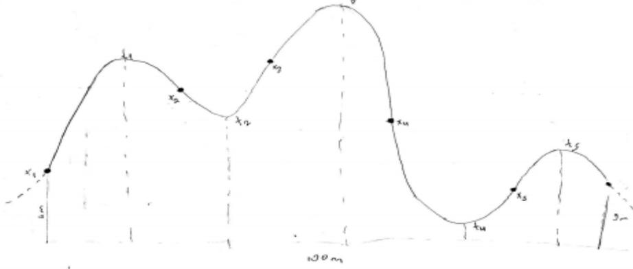
Şurada ki düştürdüğümüz model de  $x_1, x_2, x_3, x_4, x_5$  noktaları bulunabileceği eğrinin max eğim noktalarıdır. Eğer ki bu noktaların  $s, e$  den başka olduğu garanti edilebilirse tren için istenilen güvenlik koşulları sağlanmış oluruz. Çünkü bu noktalar tren yaylarının üzerine kurulacağı, eğri parçalarının ta bütünlüğü dış bütünlüğe geçiş noktalarıdır.
