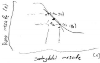
Şöyle ki  $x_2$  noktasının eğimi bulmak için;  $x_2$ 'nin  $\delta$  konsantrasyondaki iki noktası  $x$  ve  $y$  değerleri bulunur. Bu değerler bulunulduktan sonra iki nokta arası eğim formülünü kullanarak  $x_2$ 'nin eğimi hesaplanır (çünkü diğer formül).
