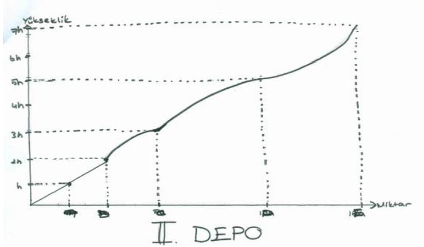
Depo 2 klasik sıvık hana balonu setline sahiptir Ayrıca deponun altı düzün silindirik zelle sahiptir Bu sebeple grafikimizin ilk kısmı düzün doğrusal artan bir artış gösterir Deponun ikinci kısmı ise kesik koni şeklindedir Bu nedenle grafikimizin ikinci kısmı azalarak artmaktadır. Kesik koninin üstündeki düzün kürenin eğiminin, koninin eğimine göre daha fazla olması sebebiyle ise azalarak artan grafikte keskin azalma görülmüştür. Bu kısımdan sonra grafik hızlanarak artmaktadır.
