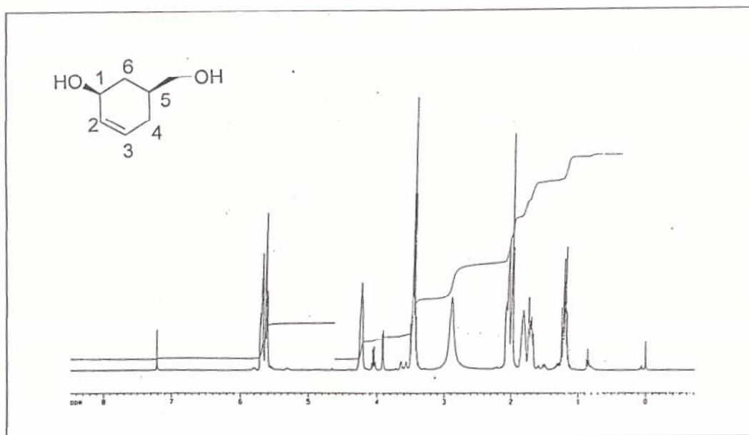
Figure 24.  $^1\text{H}$ -NMR Spectrum of (-)-5-(Hydroxymethyl)-2-cyclohexen-1-ol (19)
