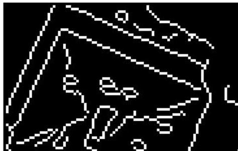
**Figure 14 Canny Edge Detector Output**
