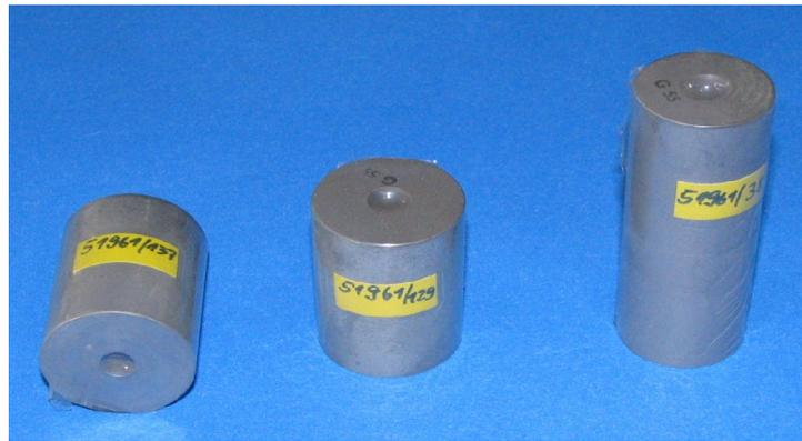
**Figure 3.4.** Tungsten carbide inserts
