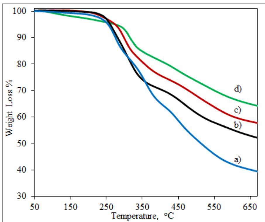
Figure 3.19. TGA curves of a) PPab polymer, b) PPab/5BPDBA, c) PPab/10BPDBA and d) PPab/15BPDBA
