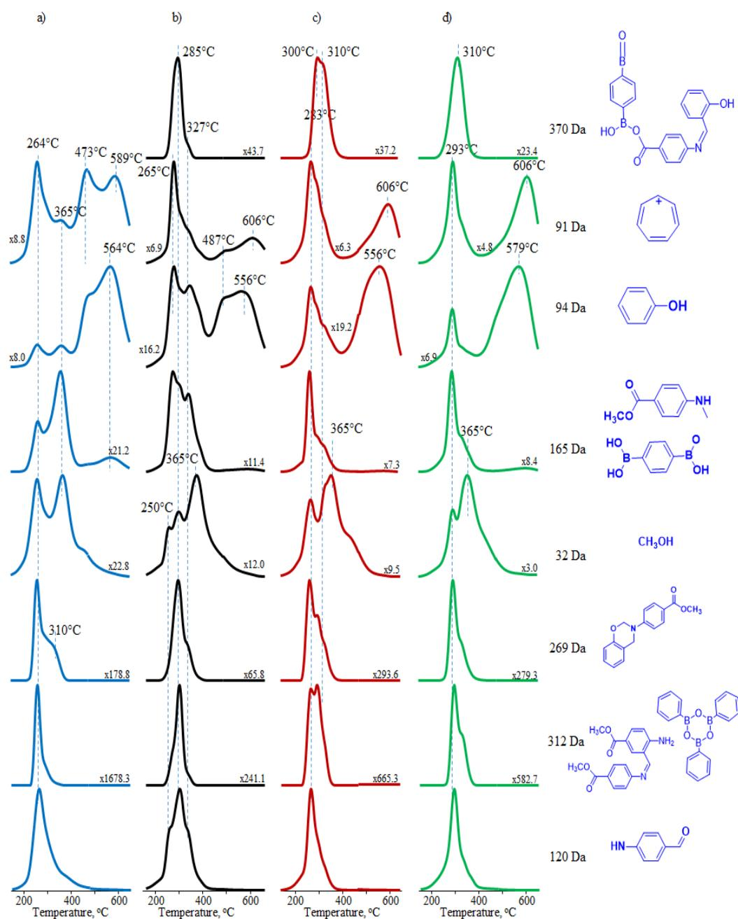
Figure 3.16. Single ion evolution profiles of a) PPab, b) PPab/5BDDBA, c) PPab/10BDDBA and d) PPab/15BDDBA
