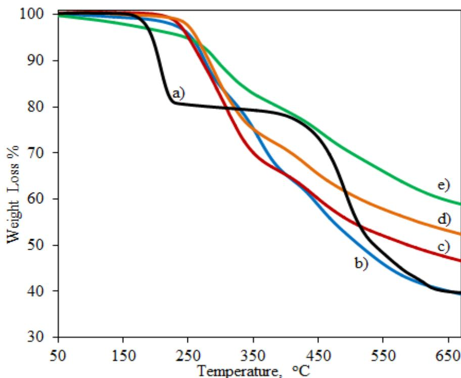
Figure 3.14. TGA curves of a) BDBA, b) PPab polymer, c) PPab/5BDBA, d) PPab/10BDBA and e) 15BDBA
