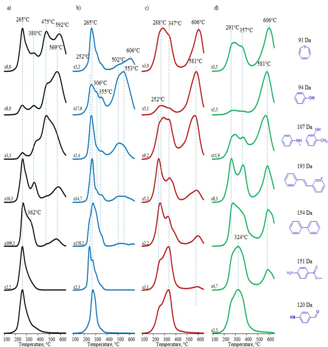
Figure 3.21. Single ion evolution profiles of a) PPab, b) PPab/5BPDBA, c) PPab/10BPDBA and d) PPab/15BPDBA
