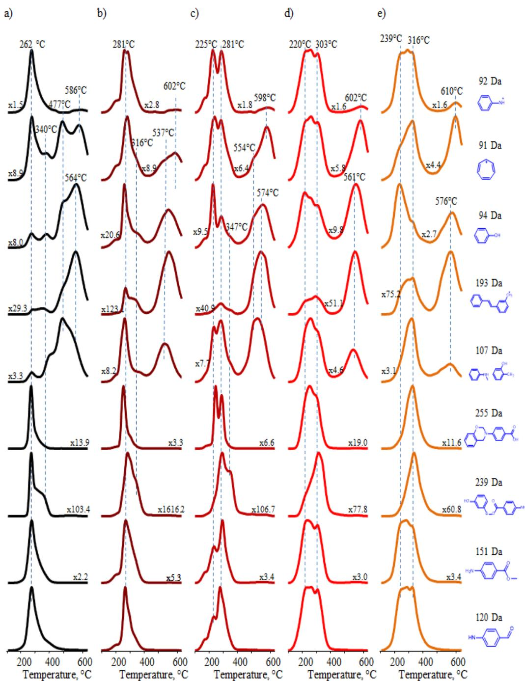
Figure 3.26. Single ion evolution profiles of a) PPab, b) PPab/2.5HPBA, c) PPab/5HPBA, d) PPab/7.5HPBA and e) PPab/10HPBA
