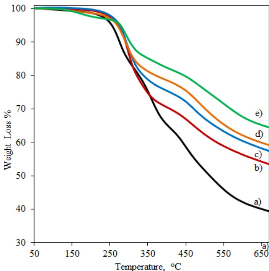
Figure 3.24. TGA curves of a) PPab, b) PPab/2.5HPBA, c) PPab/5HPBA, d) PPab/7.5HPBA and e) PPab/10HPBA
