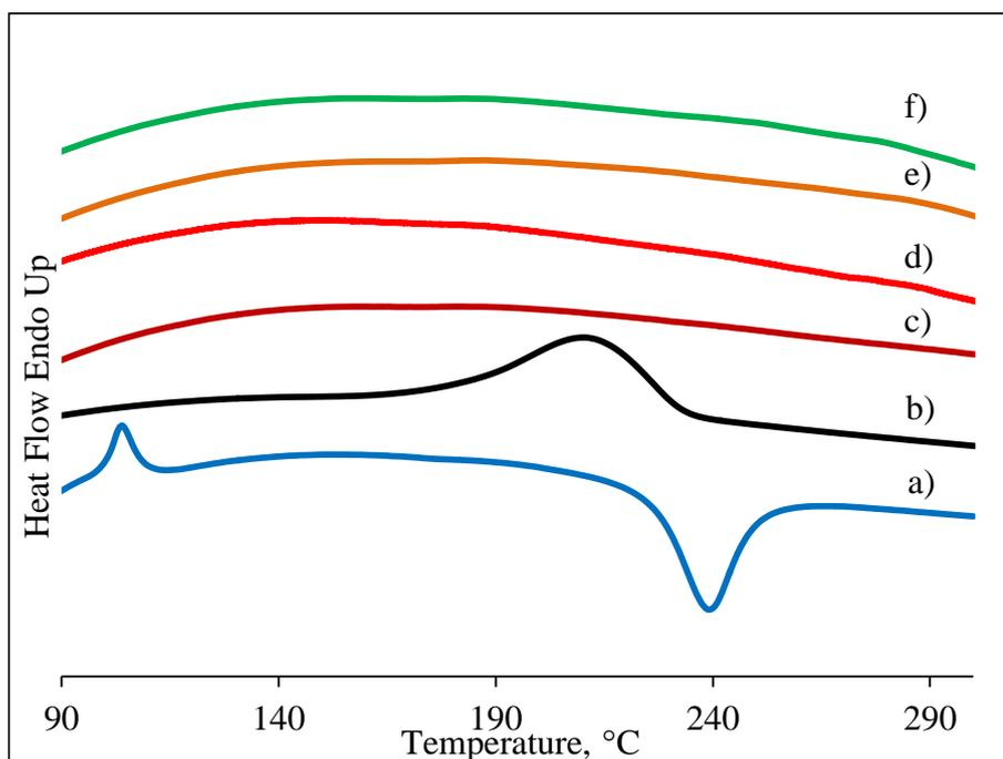
Figure 3.13. DSC curves of a) Pab monomer, b) BDBA, c) PPab polymer, d) PPab/5BDBA, e) PPab/10BDBA and f) 15BDBA
