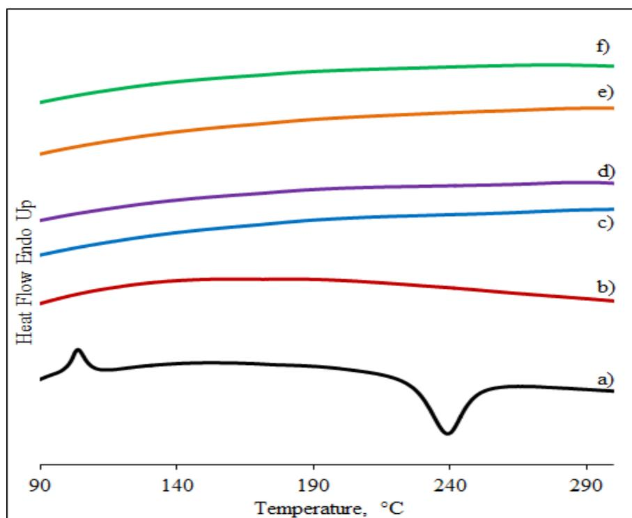
Figure 3.23. DSC curves of a) Pab, b) PPab, c) PPab/2.5HPBA, d) PPab/5HPBA, e) PPab/7.5HPBA and f) PPab/10HPBA
