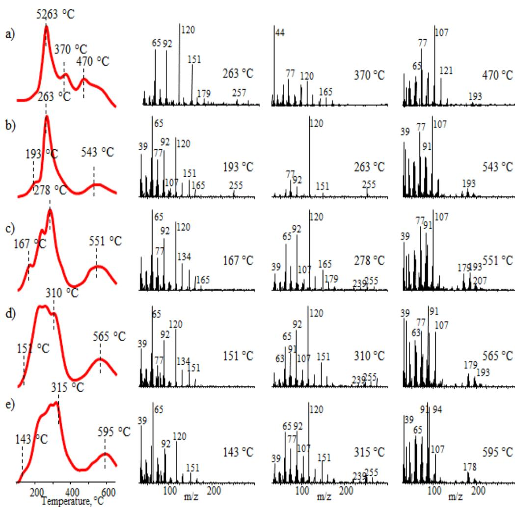
Figure 3.25 Total ion current curves and mass spectra of a) PPab, b) PPab/2.5HPBA, c) PPab/5HPBA, d) PPab/7.5HPBA and e) PPab/10HPBA
