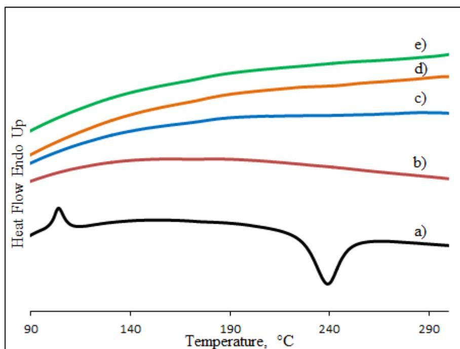
Figure 3.18. DSC curves of a) Pab monomer, b) PPab polymer, c) PPab/5BPDBA, d) PPab/10BPDBA and f) PPab/15BPDBA
