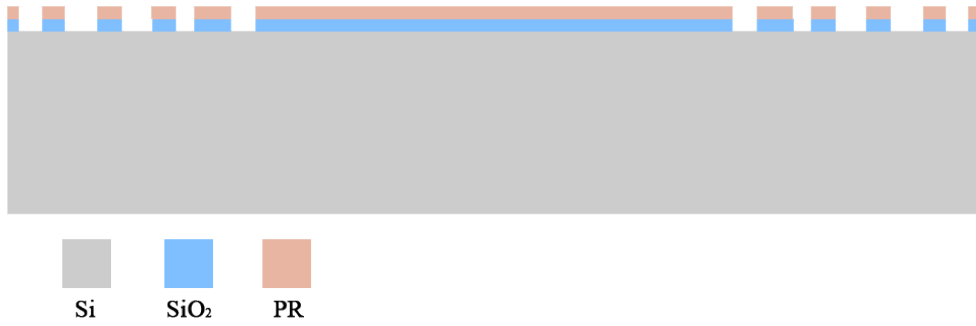
(d) The SiO 2 is patterned using wet etching.
