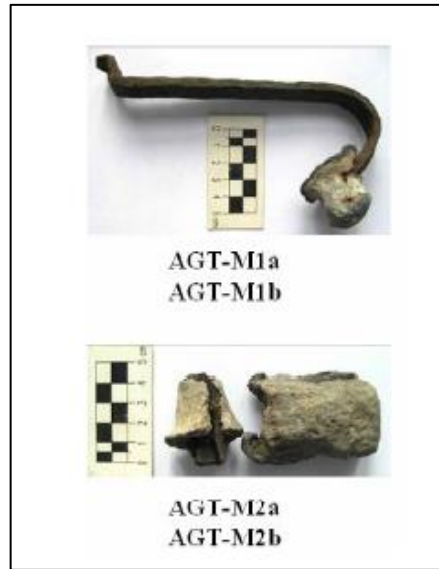
Figure 1.15: Iron connector samples from the Temple of Augustus. From Augustus Tapınađı 2008 Yılı Arkeometrik alıřmaları , Y. K. Kadiođlu & A.A. Akyol, 2008.
