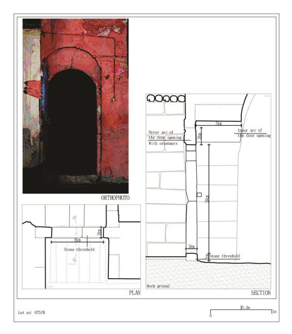
Figure 3. 101 Arch spanned door
