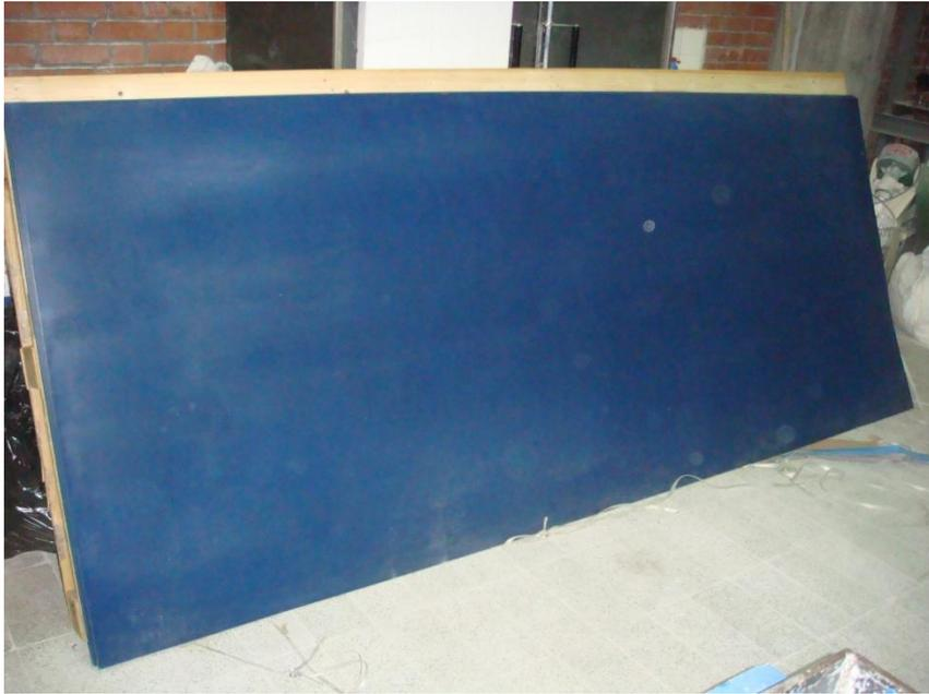
Fig. 3.21 The UHMWPE geomembrane sheet
