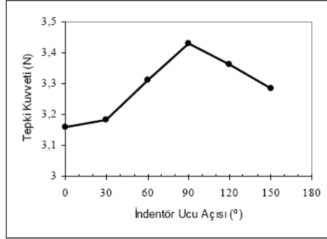
Şekil 3.2. 18 mm lik yer değiştirme ve 8 mm/s hız altında ön kol üzerinde gerçekleştirilen ölçüm sonucu. Deneyde büyük eksenli 8 mm olan uç kullanılmıştır.
