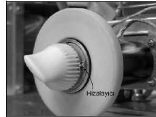
Şekil 2.6. Hizalayıcı uç ve yollar yardımıyla 10^\circ lik aralıklarla ölçümler yapılabilmektedir.
